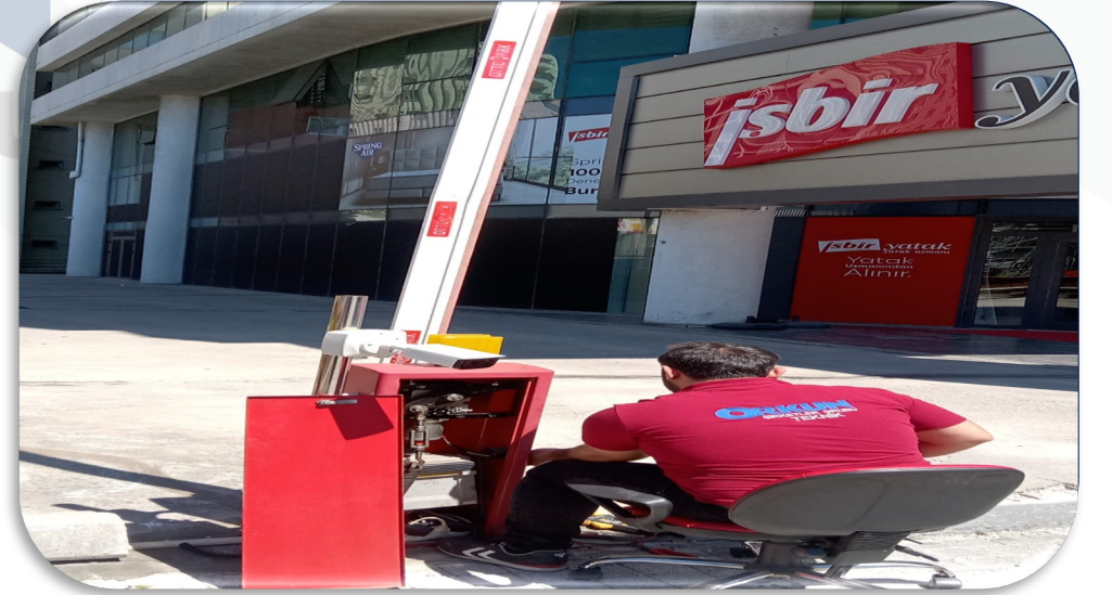
Bariyer kolunun arızalı fotoseli yenisi ile deėiŖtirilmiŖtir.
